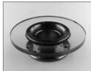
Horizontalkreis des Theodolits DKM3. Aussendurchmesser des Glaskreises 104 mm, Durchmesser der Kreisteilung 100 mm. Die Teilstriche sind 0.2 mm lang und 0.005 mm dick. Bild: H. Aeschlimann
