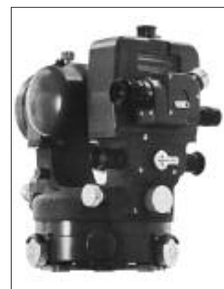
Theodolit DKM3 für Messungen höchster Genauigkeit. Erheblich umkonstruiert kam er um 1955 auf den Markt und wurde ein Weiterfolg. Die ursprüngliche Version ist auf Seite 3 mit der Bezeichnung DK2 abgebildet. Sammlung Kern
